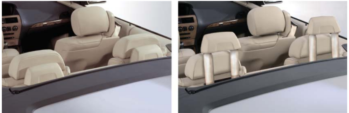
Überrollschutz der 6er-Reihe E64 in Normallage und ausgelöst (rechts)
