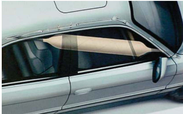
ITS nicht ausgelöst (im Dachbereich) und ausgelöst
