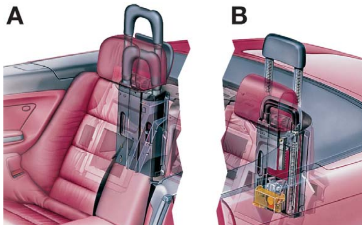
Ausgelöstes Überrollschutzsystem der 3er-Reihe E46 (A) und E36 (B) Cabrio
