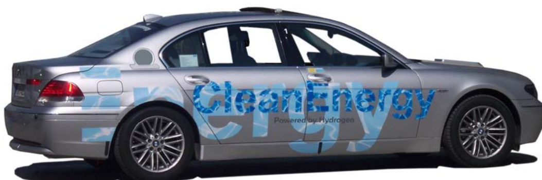
Erprobungsfahrzeug: BMW 7er mit Wasserstoffverbrennungsmotor
