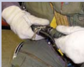
2| Beatmungsschlauch rechts und links der Kupplung anfassen, zusammen-drücken und drehen.
