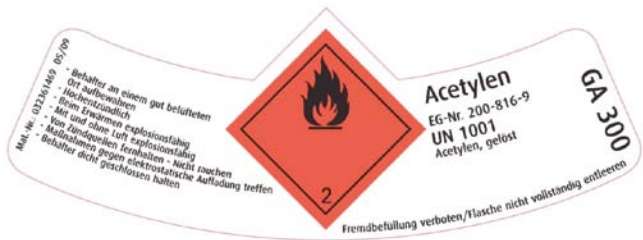
Abb. 2: Etikett für eine Gasflasche nach Transportrecht und Stoffrichtlinie
