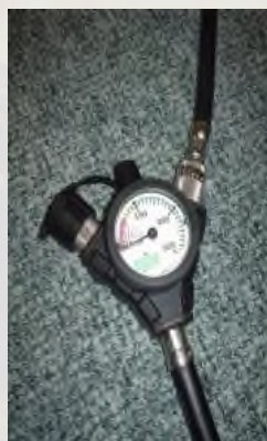
Manometer mit Zweitanschluß und Warneinrichtung
