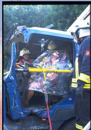
2. Schritt: Wegdrücken der Fahrzeugfront
