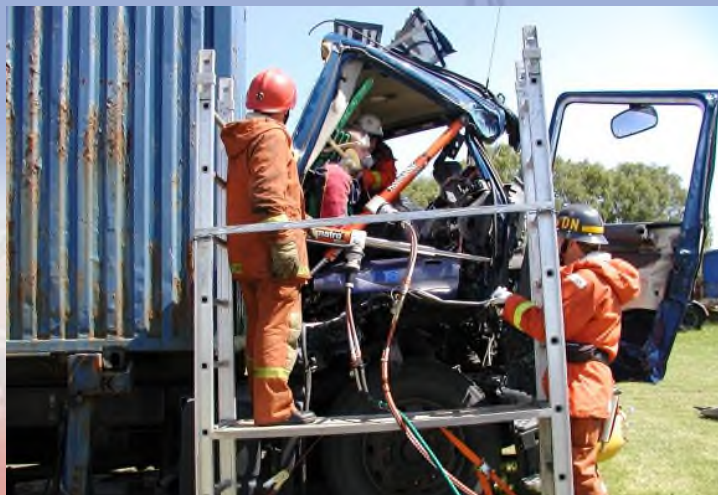
Hochdrücken des Fahrzeugdaches mit langem Rettungszylinder
