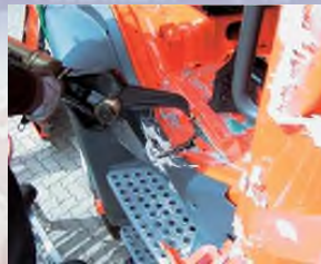
Entlastungsschnitt im vorderen Drittel des Schwellers
