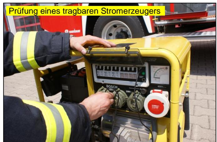
Prüfung eines tragbaren Stromerzeugers
