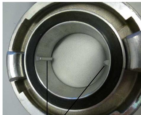
Bild 3 (©KUVB) Innenliegender Gewindestutzen mit Stegen für Spezialwerkzeug
