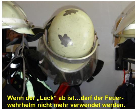
Wenn der „Lack“ ab ist...darf der Feuerwehrhelm nicht mehr verwendet werden.
