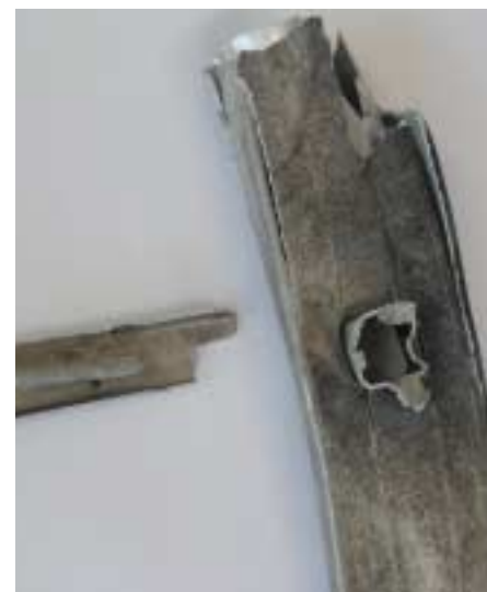
Durch starke Brandeinwirkung versprödete und gebrochene Steckleiter
