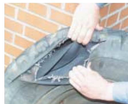
An der Innenfläche aufgeplatzt: der 22 Jahre alte Reifen eines Tank- löschfahrzeugs.
