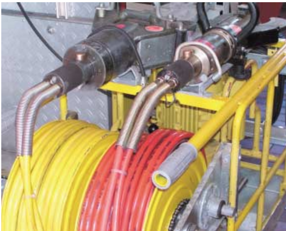
Sollten nicht mehr repariert werden: Hydraulikleitungen der Rettungsgeräte
