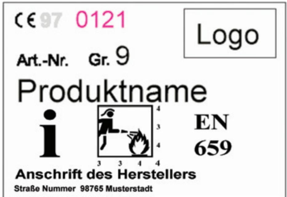
Beispiel für die Kennzeichnung eines Handschuhs nach DIN EN 659
