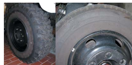
Reifen – ein häufig wenig beachteter Teil des Feuerfahrzeuges. Die DOT-Kennzeichnung gibt Aufschluss über das Herstellungsdatum des Reifens
