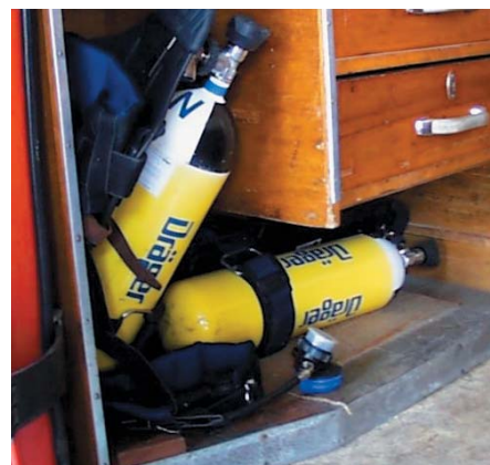
Mangelhafte Transportsicherheit im Feuerwehrfahrzeug
