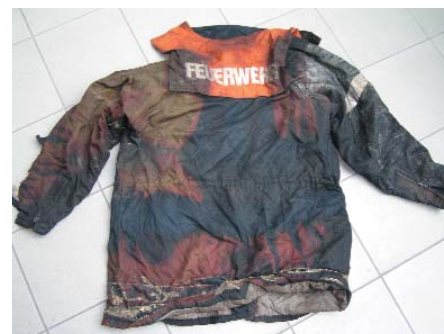
Die Einsatzschutzjacke – Spuren massiver Hitzeeinwirkung
