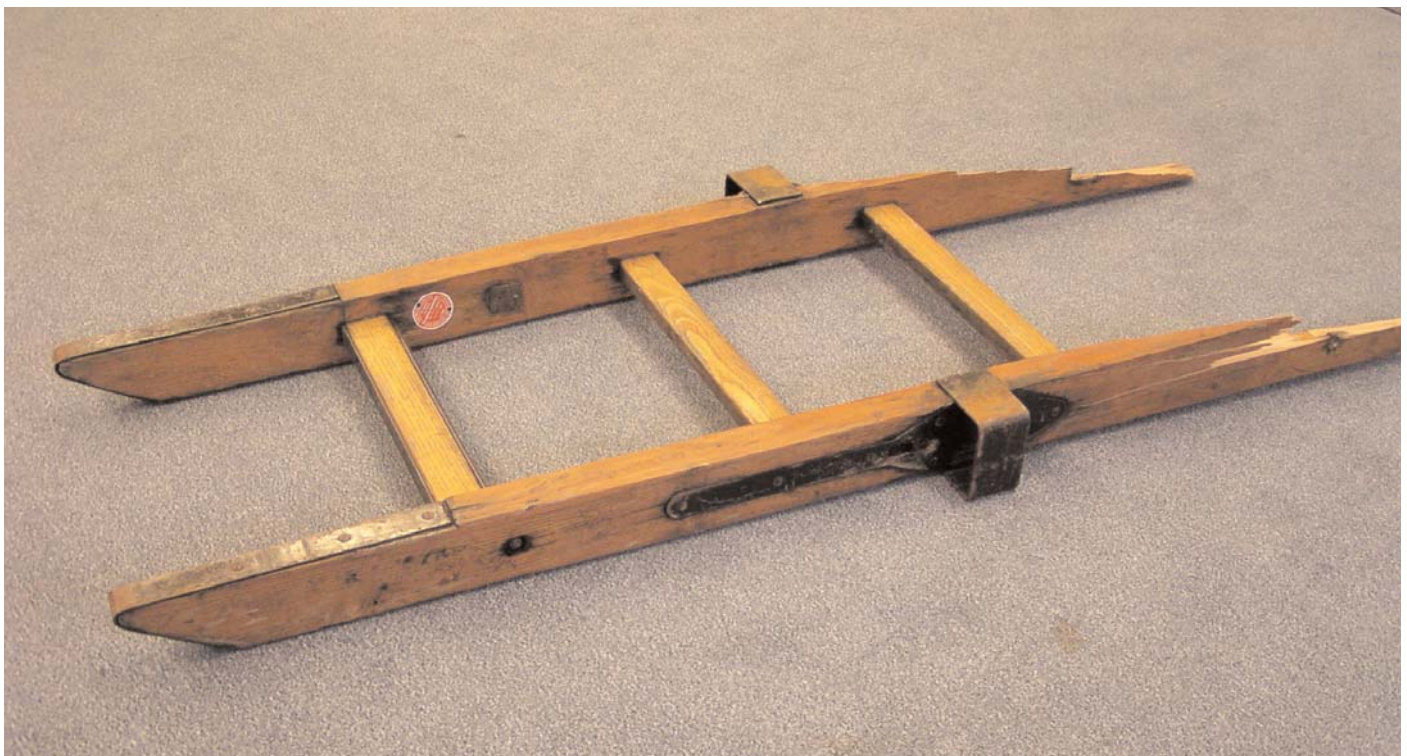
Zerbrochen: Steckleiterteil aus Holz
