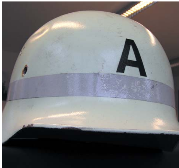
Recht unscheinbar aber bei hohen Temperaturen gefährlich: Helm aus Textil-Phenol-Kunstharz.
