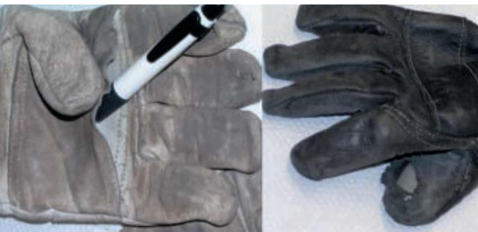
Kaputte Handschuhe – mit diesen Löchern auf keinen Fall mehr einsetzbar
