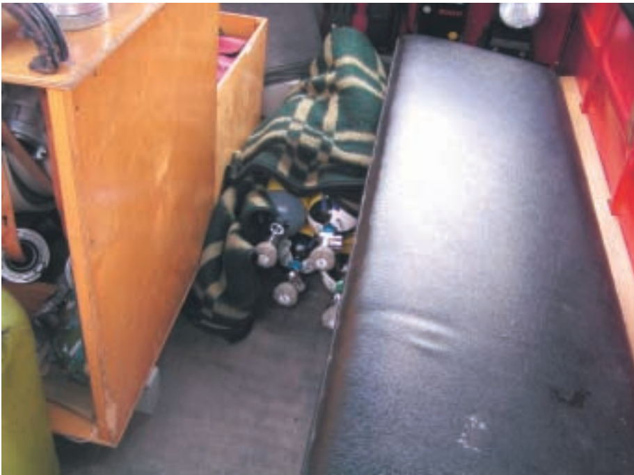
Was wohl mit den losen Atemluftflaschen im Mannschaftsraum passiert, wenn das Feuerwehrfahrzeug verunglückt ???
