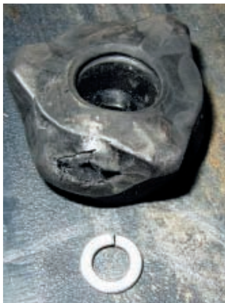
Im Detail - das abgerissene Handrad
