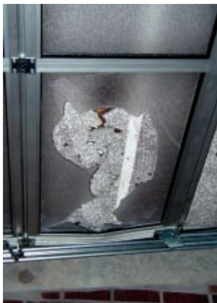
Die Flasche durchschlug das Tor locker
