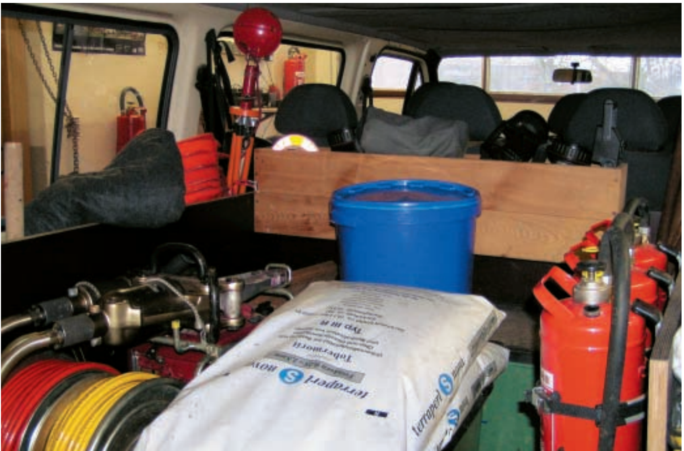
Heillosos Durcheinander: Viele Geräte sind unzureichend gesichert.
