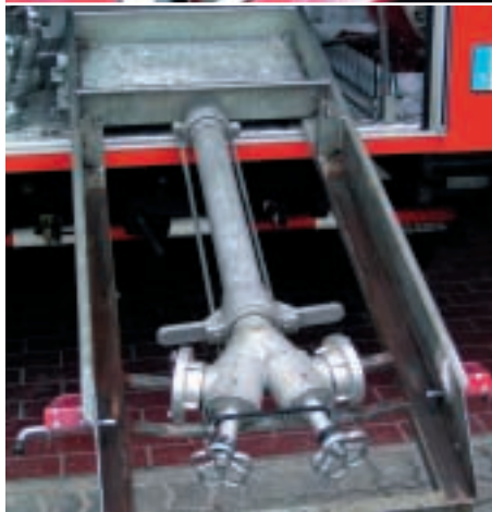
Schmerzende Handverletzung möglich: Verhakt sich beim Einschleiben des TS-Schlittens die Klauenmutter an der Fahrzeugkante, schieben sich die Niederschraubventile gegen die Hände ...
