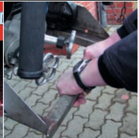
Schmerzende Handverletzung möglich: Verhakt sich beim Einschleiben des TS-Schlittens die Klauenmutter an der Fahrzeugkante, schieben sich die Niederschraubventile gegen die Hände ...
