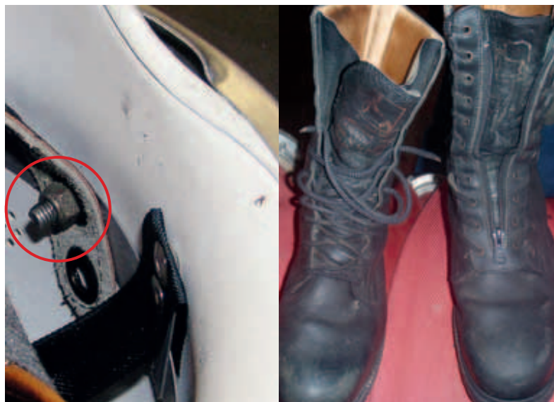
links: Verletzungsgefahr durch in den Schutzraum überstehenden und scharfkantigen Gewindebolzen – keine Originalverbindung!
