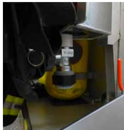
Positiv an diesen Lagerungsvarianten: Ventilschutz (links), frei in der Luft hängendes Ventil durch aufsitzende Lagerung der Atemluftflasche (rechts).
