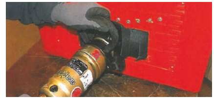
Die Mitarbeiter der Kreisfeuerwehrzentrale Steinburg erfanden die innovative Splitterschutzbox für die sichere Prüfung hydraulischer Rettungsgeräte.
