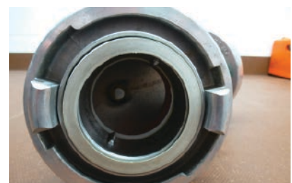
Hier sind die Stege erkennbar, in denen das Spezialwerkzeug eingreift.
