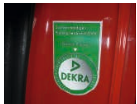
» An der Prüflakette ist der nächste Termin für die Sicherheitsüberprüfung erkennbar.
