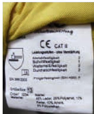
» Negativbeispiel: Kennzeichnung eines TH-Handsuhes mit geringeren Leistungsstufen als beim Feuerwehrhandschuh
