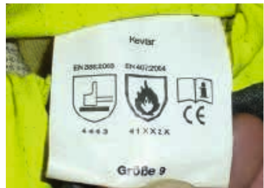
» Positivbeispiel: Kennzeichnung eines TH-Handsuhes, der die Mindestleistungsstufen für die mechanischen Gefahren und zusätzlich einige Gefahren gegen thermische Risiken erfüllt
