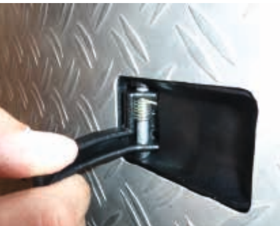
» Neuer Türöffner mit intakter Feder
