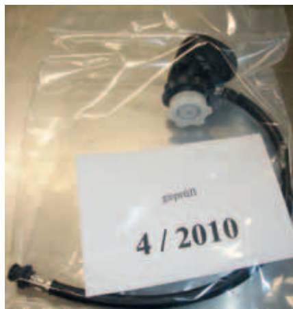
geprüfter und eingeschweißter Lungenautomat
