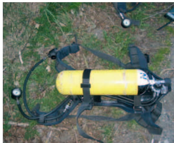
So nicht – ein Negativbeispiel! PA mit ungeschütztem Lungenautomaten einfach im Straßengraben „abgelegt“.
